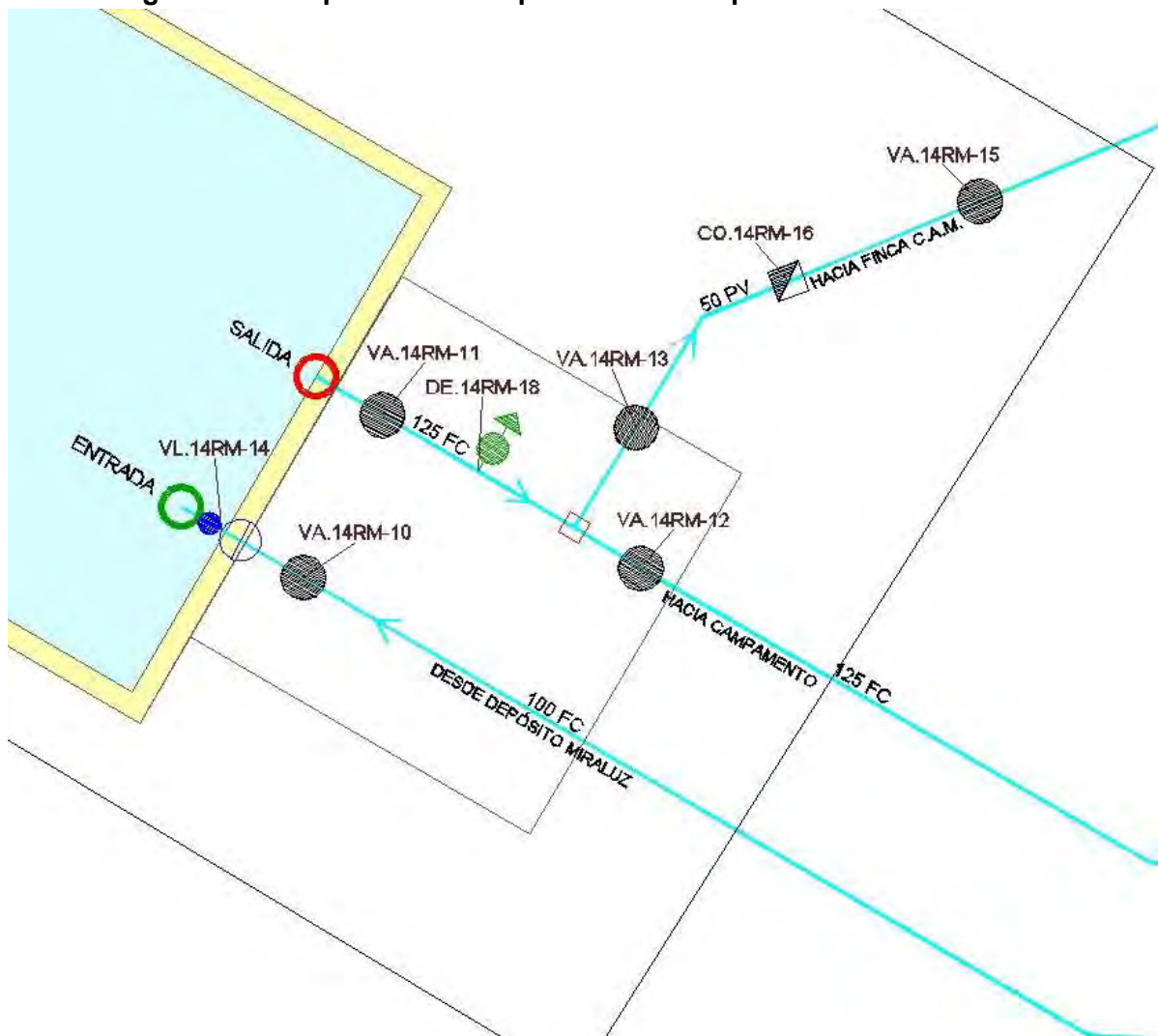
Figura nº 7. Depósito de Campamento Riosequillo. Cámara de llaves.
