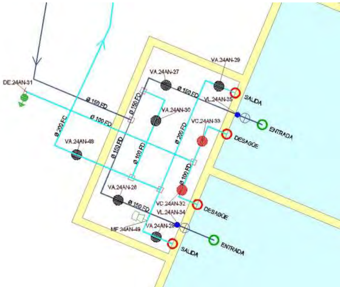
Figura nº 5. Depósito de Miraluz. Cámara de llaves.
